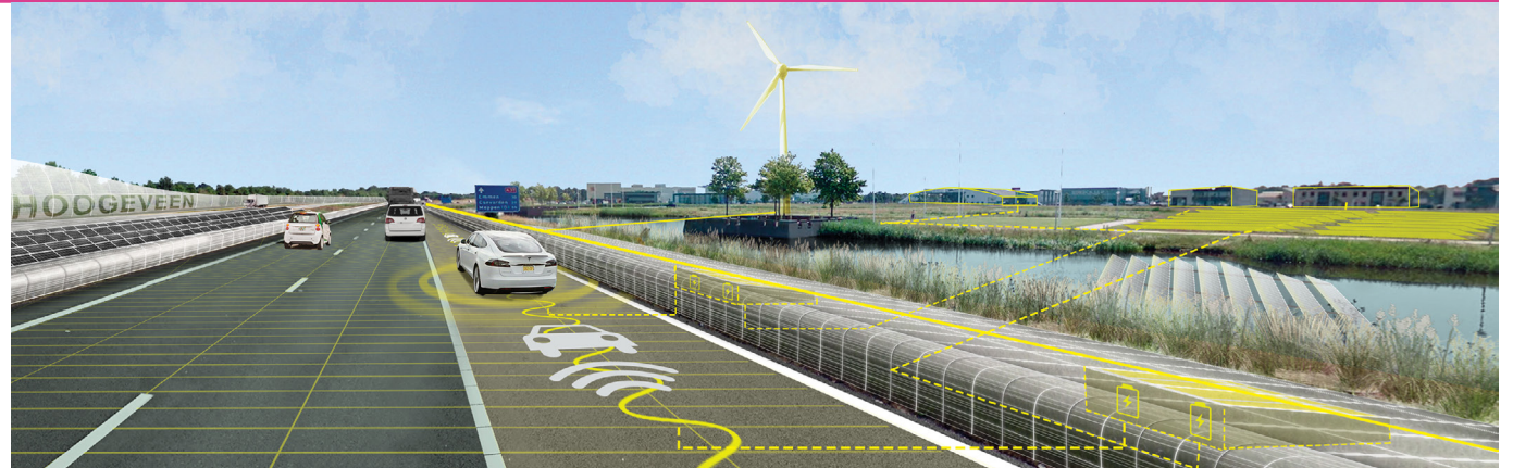
Modulaire systemen: zon geïntegreerd in de geleiderail, onderdeel van de nieuwe snelweggramatica (Solarroute A37)
